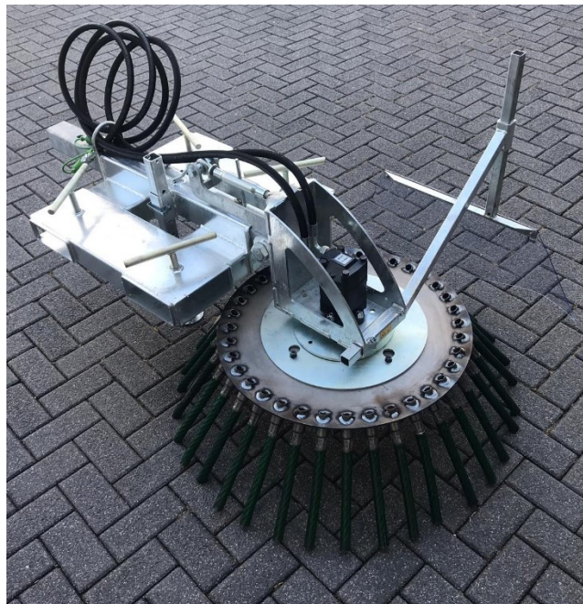
Uitgevoerd met borstel 700x36 kabels (optie)
