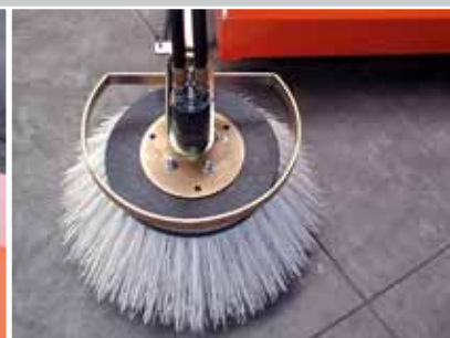
Seitenkehrbesen hydraulisch angetrieben
