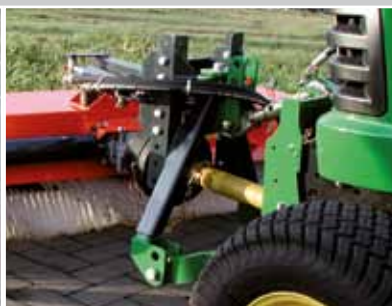
mechanischer Antrieb für Drehzahlen von 540 bis 2100 /min
